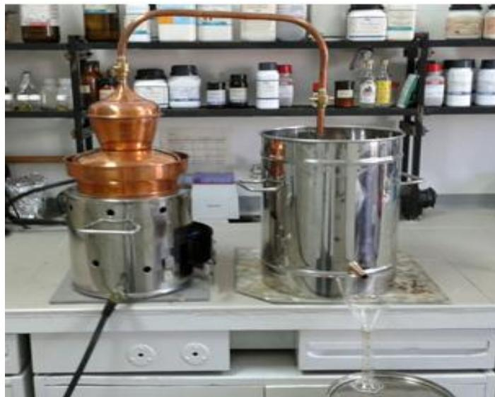
**Slika 6.** Laboratorijski šaržni kotao za destilaciju (vlastita fotografija).
