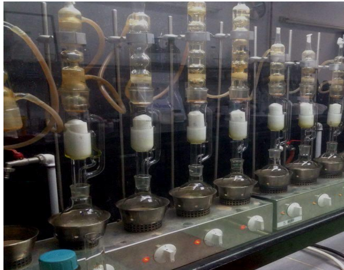
Slika 5. Aparatura po Soxhletu (vlastita fotografija)
