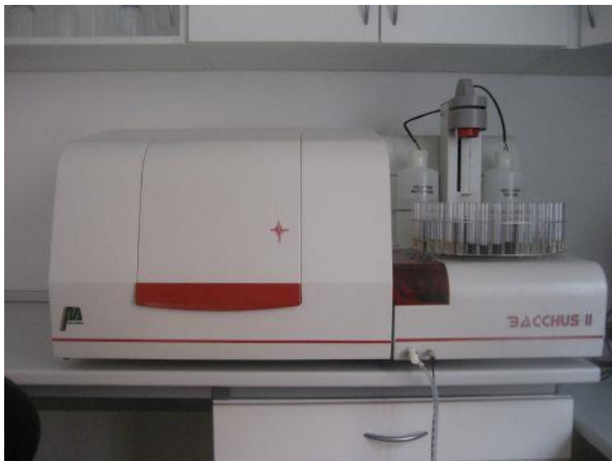
Slika 2. FTIR spektrometar, Bacchus , Microdom, Francuska (Skoog, 2007)
