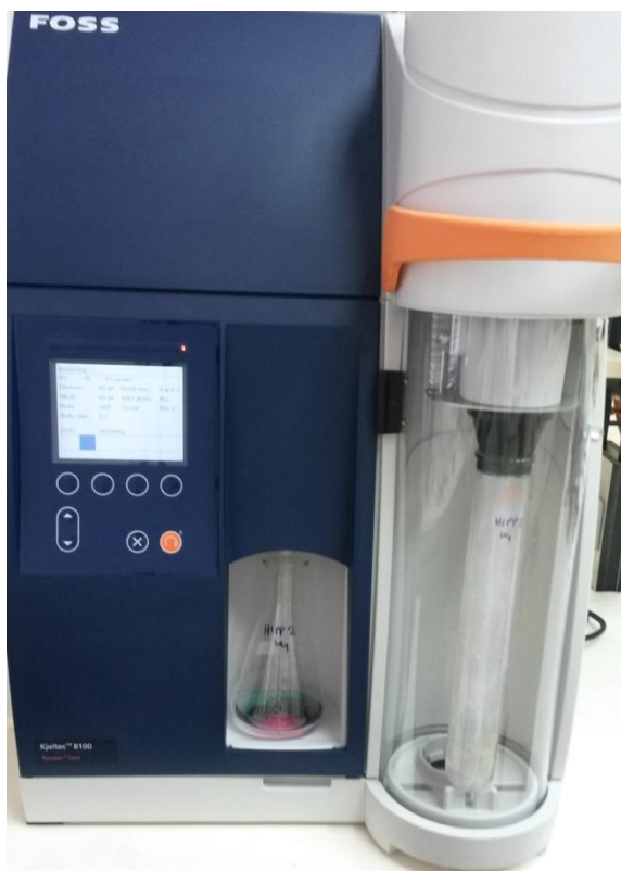
Fotografija Kjeltec uređaja s uzorkom u trećoj minuti destilacije
