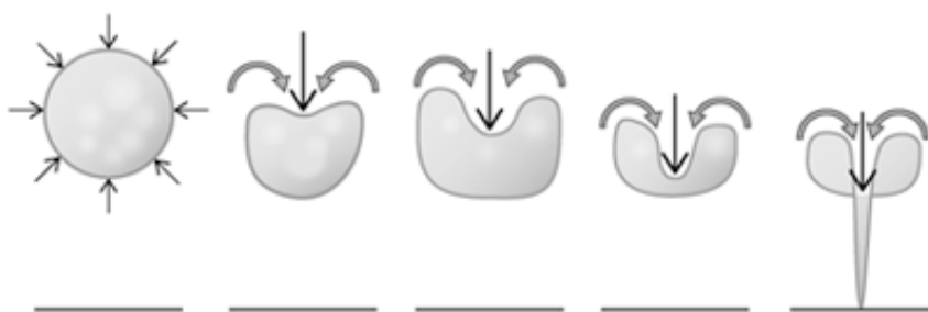
Slika 4. Grafički prikaz implozije kavitacijskog mjehurića (Acoustical Society of America, 2013)
