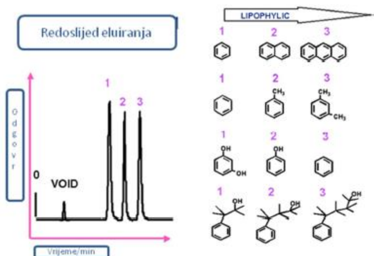
Slika 7. Razdvajanje spojeva s tekućinskom kromatografijom obrnutih faza
