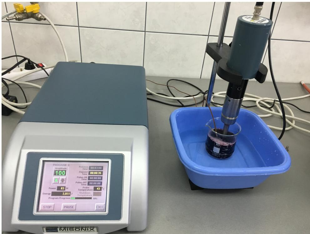
**Slika 3.** Ultrazvučni procesor S-4000, Misonix Sonicators, Newtown, USA
