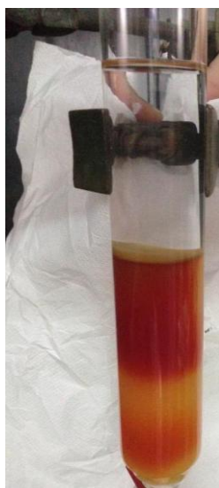
Slika 13. Kromatografska kolona na stupcu od silika gela pri pročišćavanju smjese N7- i N9-ferocenoil-adenina
