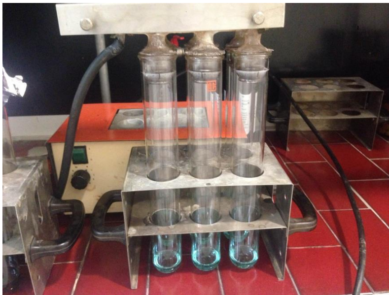
Slika 13. Blok za mokro spaljivanje uzorka kod Kjeldahl-ovog postupka (vlastita fotografija)
