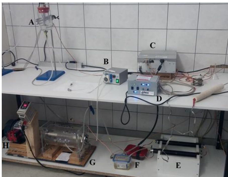
Slika 2. Sustav za generiranje plazme u tekućini visokonaponskim pražnjenjem: A) reaktor, B) pumpa, C) visokonaponski generator D) kontrolna jedinica za napajanje, E) otpornici 9,5 M \Omega F) kondenzator 0,75 nF G) rotirajuća sklopka, H) elektromotor s regulatorom frekvencije
