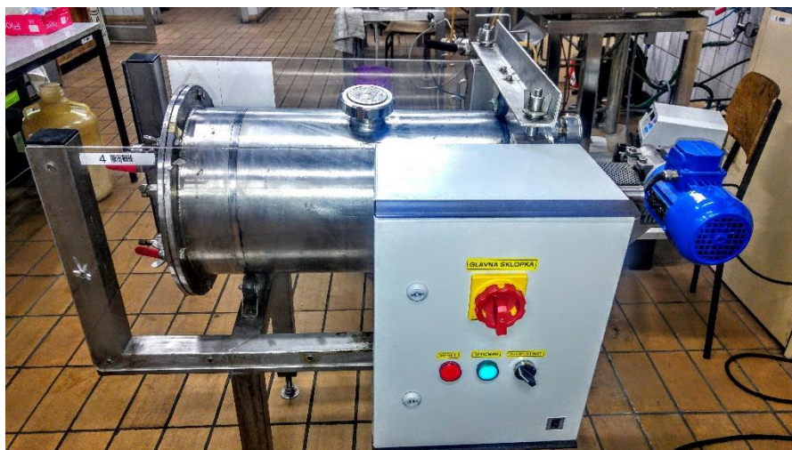
Slika 4. Horizontalni rotirajući cijevni bioreaktor (Rosing d.o.o., Hrvatska)
