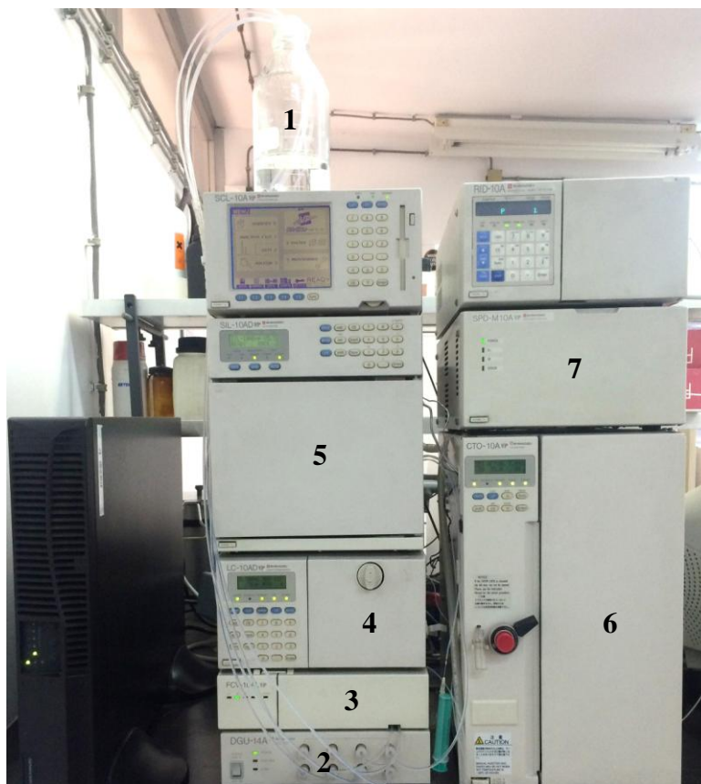
Slika 8. Kromatograf Shimadzu CLASS-VP LC-10A VP (Shimadzu; Kyoto, Japan). 1 - boca za pokretnu fazu; 2 - otplinjač; 3 - podjedinica za formiranje gradijenta; 4 - pumpa; 5 - auto-injektor; 6 - pećnica s predkolonom i kolonom; 7- detektor.
