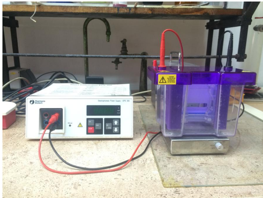
Slika 7. Sustav za vertikalnu gel elektroforezu SIGMA ALDRICH CVS10CBS omniPAGE mini dual (Sigma Aldrich, Milwaukee, SAD)
