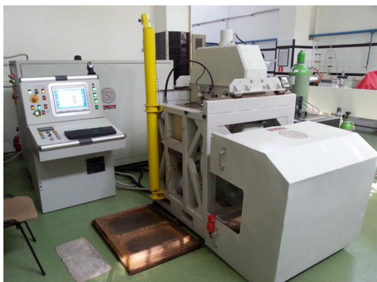
Slika 6. Uređaj za visoki tlak: Stansted Fluid Power, Velika Britanija
