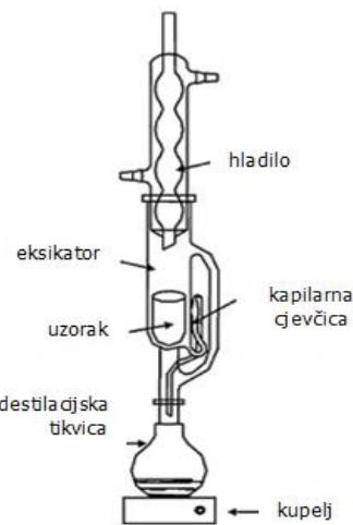
*Slika 8. Aparatura za ekstrakciju po Soxhletu [16]*
