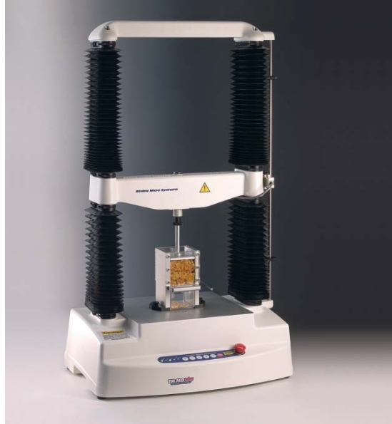
Slika 11. TA.HD.plus analizator tekture (Stable Micro Systems, Velika Britanija)
