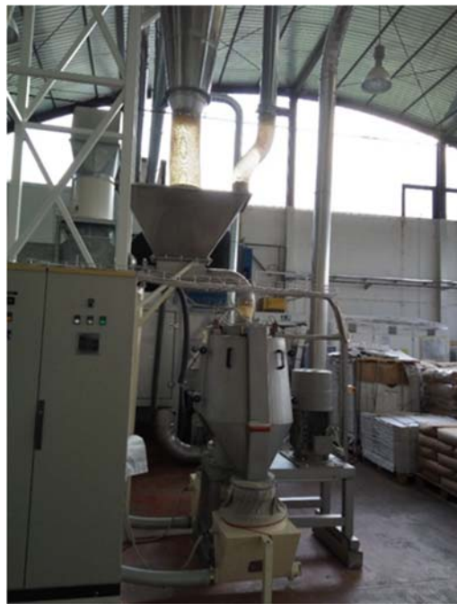
Slika 5. Mljevenje ekspanzirane kukuruzne krupice (vlastita slika)
