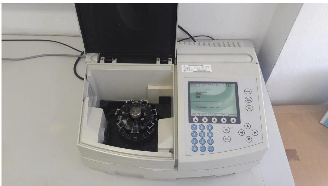
**Slika 9.** UV/Vis spektrofotometar Unicam Hellos β (vlastita fotografija)
