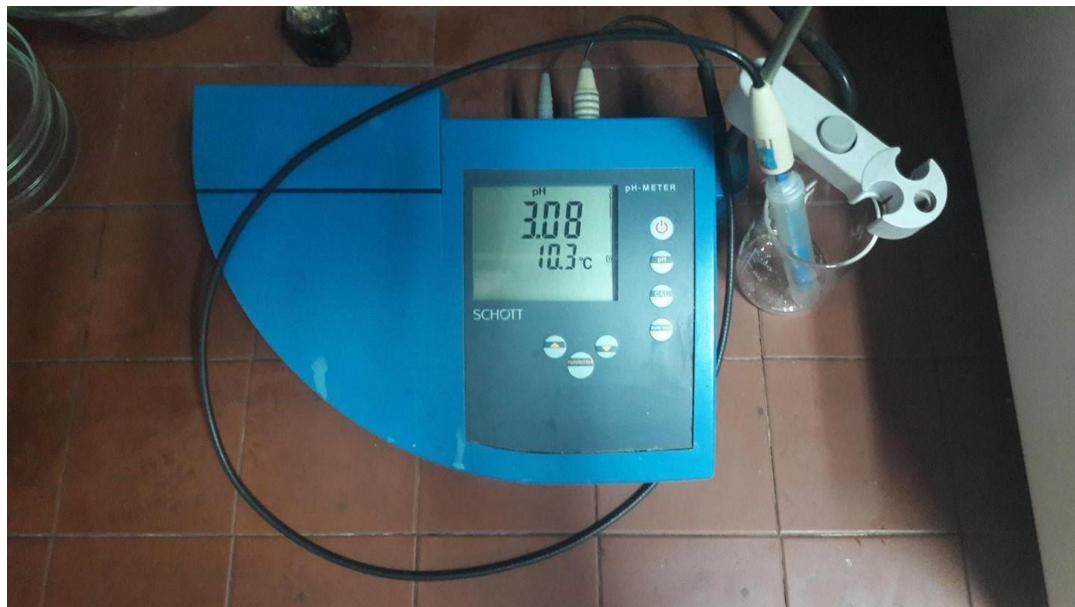
**Slika 10.** pH-metar Schott Typ:CG 842 (vlastita fotografija)
