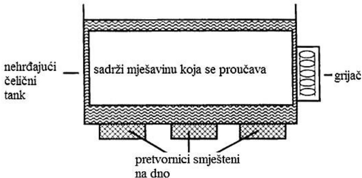
Slika 8. Ultrazvučna kupelj (Gogate i sur., 2006)
