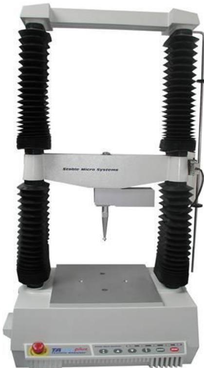
Slika 14. Analizator tekture TA. HDPlus (Stable Micro Systems, Velika Britanija)
