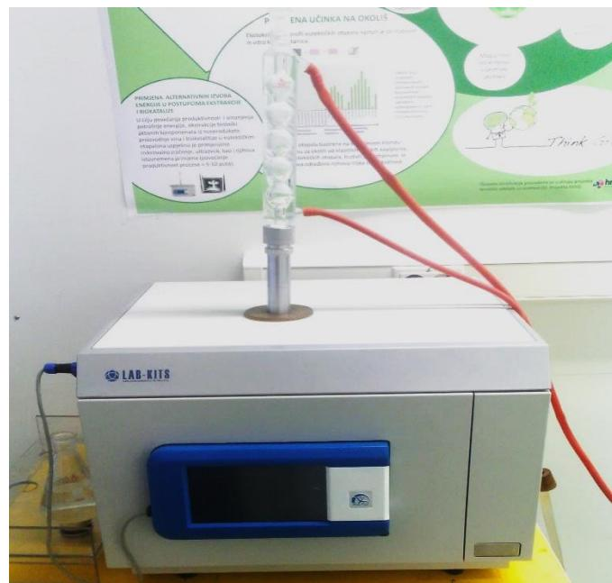
Slika 8. Mikrovalno-ulrazvučni ekstraktor (Vlastita fotografija)
