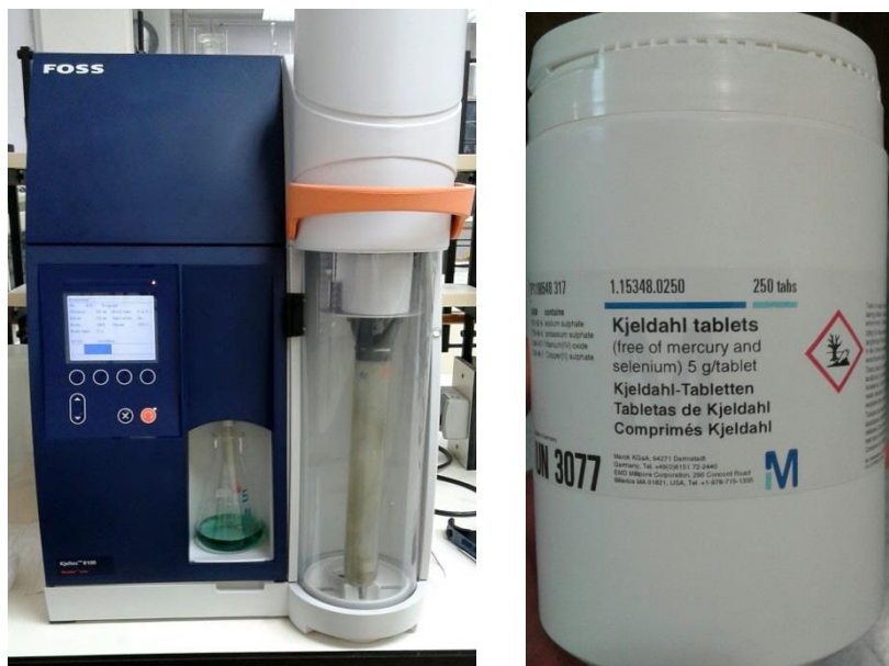
Slika 10. Automatizirani sustav za određivanje proteina Kjeltec (FOSS) i Kjeldahl tablete (Vlastita fotografija)
