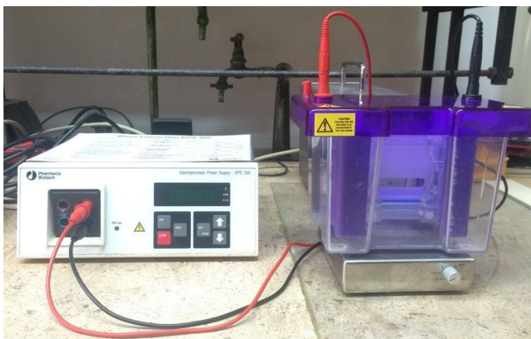
Slika 4. Sustav za vertikalnu gel elektroforezu SIGMA ALDRICH CVS10CBS omniPAGE mini dual (Sigma Aldrich, Milwaukee, SAD).
