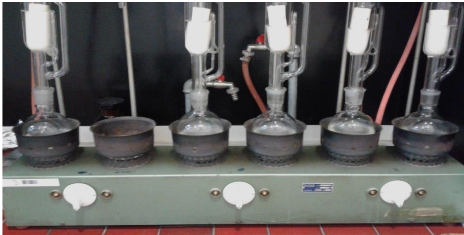
Slika 8. Određivanje masti po Soxhlet-u (vlastiti izvor)
