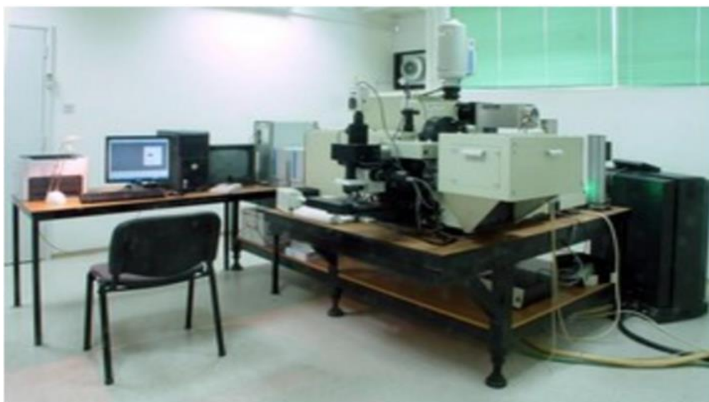
Slika 9. Horiba Jobin Yvon T640000 Ramanov spektrometar (Janči, 2016)
