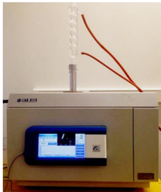
Slika 5. Ultrazvučno – mikrovalni ekstraktor (vlastita fotografija)
