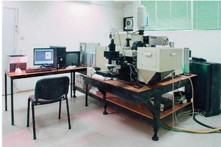
Slika 7. Horiba Jobin Yvon T64000 Ramanov spektrometar, Laboratorij za molekulsku fiziku Instituta Ruđer Bošković (Janči, 2016)
