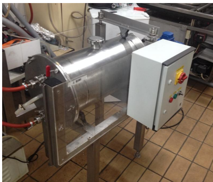
Slika 13. HRCB- Horizontalni Rotirajući Cijevni Bioreaktor
