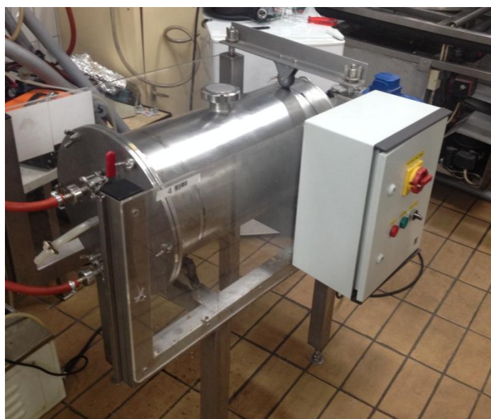
Slika 13. HRCB- Horizontalni Rotirajući Cijevni Bioreaktor
