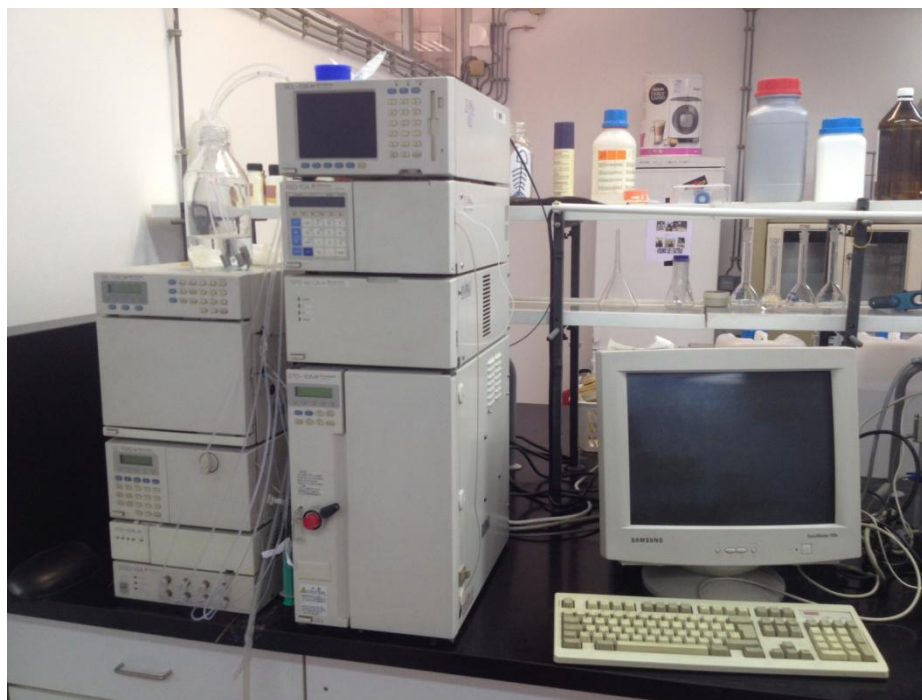
Slika 11. HPLC- uređaj za tekućinsku kromatografiju visoke učinkovitosti
