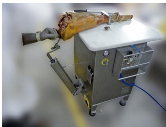
Slika 12. Uređaj za iskoštavanje pršuta (Cruells, 2017)
