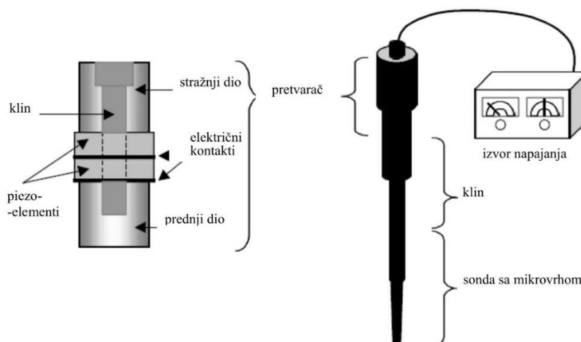
**Slika 2.** Ultrazvuk visokog intenziteta u obliku sonde s piezoelektričnim pretvaračem u obliku “sendviča” (Režek Jambrak i sur., 2010)
