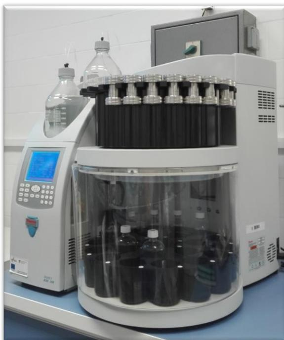
**Slika 6.** Uređaj za ubrzanu ekstrakciju otapalom (vlastita fotografija)
