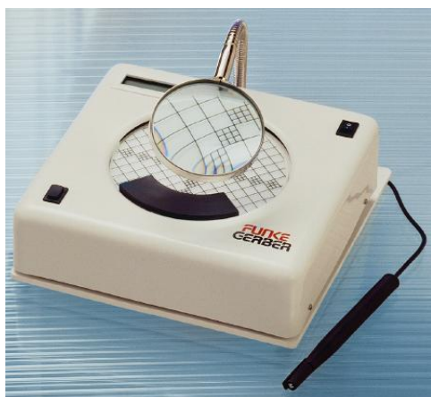
Slika 10. Brojač kolonija, Funke Gerber – Colonystar bacteria counter (Anonymus 3, 2016)
