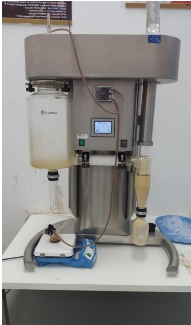
Slika 3. Uređaj za sušenje raspršivanjem (vlastita fotografija)
