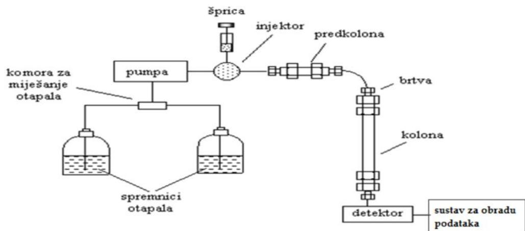
Slika 6. Shematski prikaz HPLC uređaja (Luterotti, 2009)
