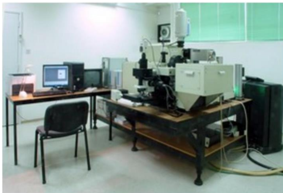
Slika 9. Horiba Jobin Yvon T640000 Ramanov spektrometar (Janči, 2016)
