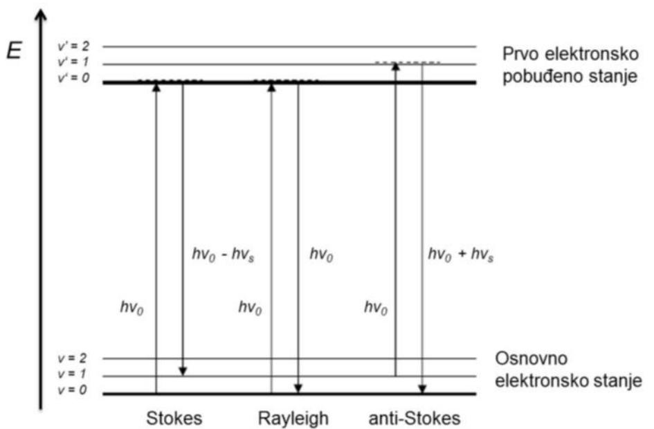
Slika 4. Shematski prikaz različitih tipova raspršenja svjetlosti na molekuli pobuđenoj fotonom
