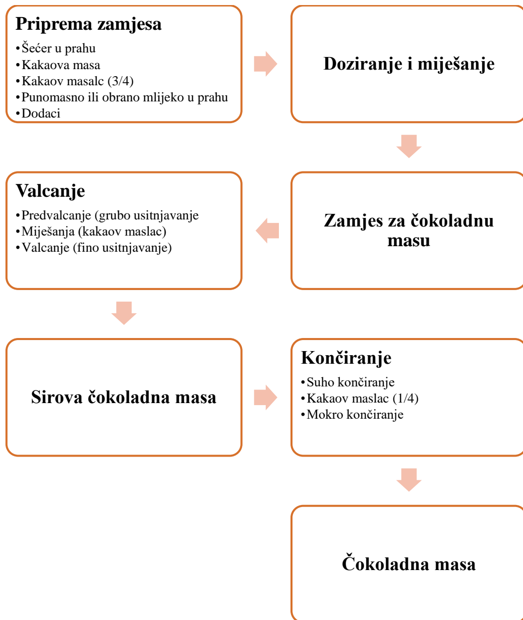
Slika 4. Shema tehnoloških operacija u izradi čokoladne mase konvencionalnim postupkom (Goldoni, 2004)
