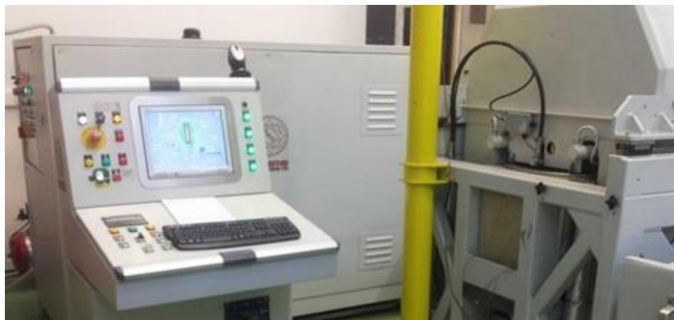
**Slika 2.** Uredaj za tretiranje visokim hidrostatskim tlakom korišten za provedbu eksperimenta (vlastita fotografija)
