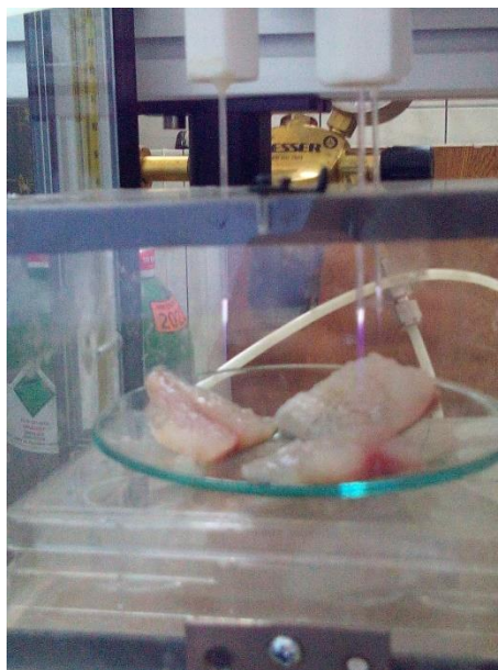
Slika 8. Uzorak ribe podvrgnut plazmi u zatvorenoj posudi pod atmosferom argona
