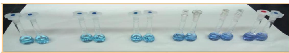
Slika 6. Pripremljene standardne otopine bovin serum albumina (BSA).
