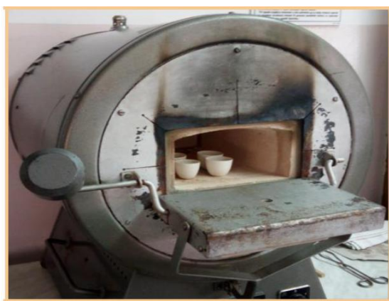
Slika 4. Žarenje uzoraka u Muffolnoj peći. 1
