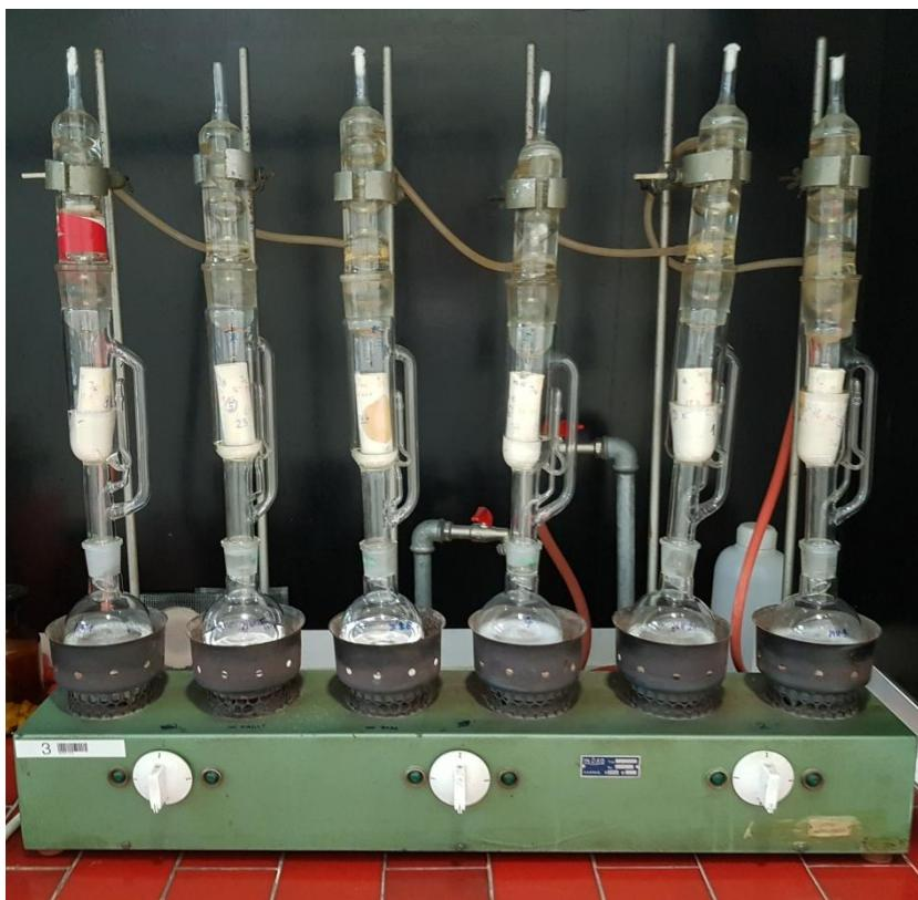
Slika 8. Aparatura po Soxhletu (vlastita fotografija)
