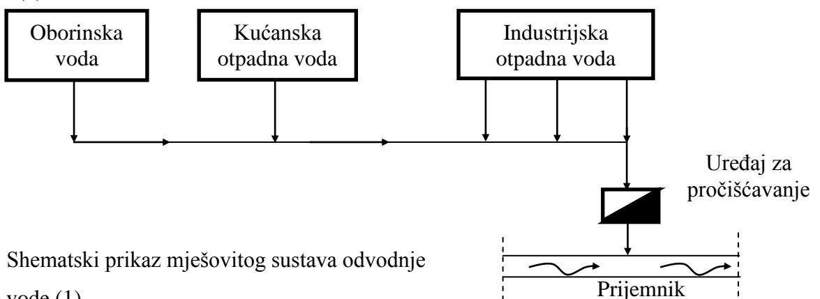
Slika 1. Shematski prikaz mješovitog sustava odvodnje otpadne vode (1)
