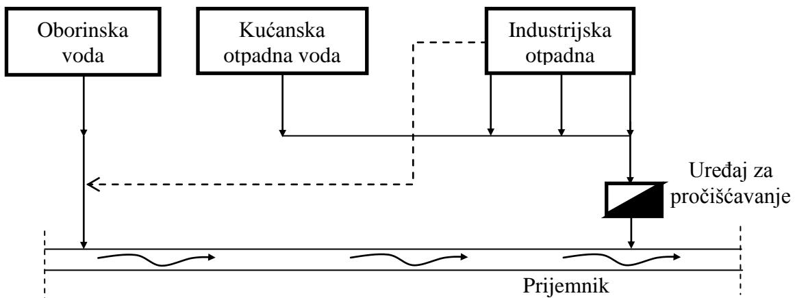
Slika 2. Shematski prikaz potpuno razdjelnog sustava odvodnje otpadne vode (1)
