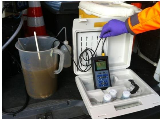
**Slika 9.** Određivanje pH vrijednosti i temperature uzorka
