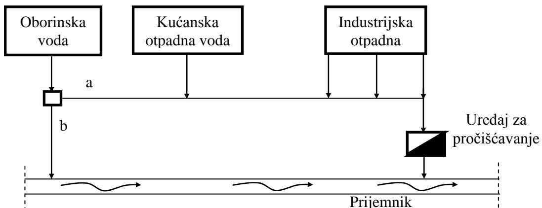
Slika 3. Shematski prikaz polurazdjelnog sustava odvodnje otpadne vode (1)
