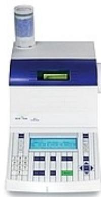
Slika 10. Uređaj za mjerjenje gustoće „Mettler Toledo Density Meter DE 40“, Švicarska (MT, 2018)
