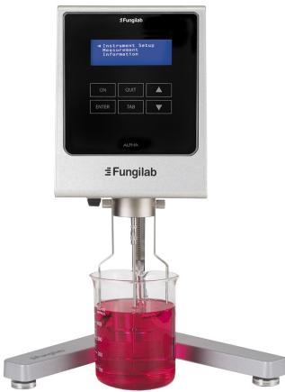
Slika 9. Uređaj za mjerjenje viskoznosti „Fungilab“ (Fungilab, 2018)
