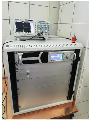
Slika 2. Prikaz "plazma generator IMP-SSPG-1200"
