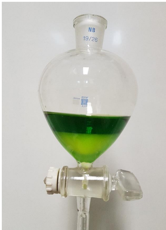
Slika 10: Razdvajanje organske i vodene faze pomoću lijevka za odjeljivanje (vlastita fotografija)
