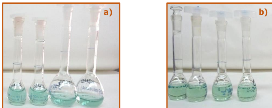
Slika 5. Otopine espresso kave (a) i otpada dobivenog njenim konzumiranjem (b) pripremljene za određivanje ukupnih proteina UV/Vis spektrofotometrijom.
