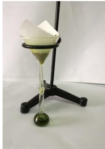
Slika 12. Filtracija preko lijevka i filter papira
