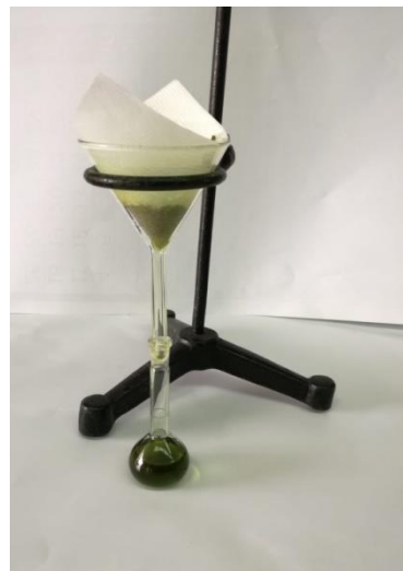
Slika 12. Filtracija preko lijevka i filter papira
