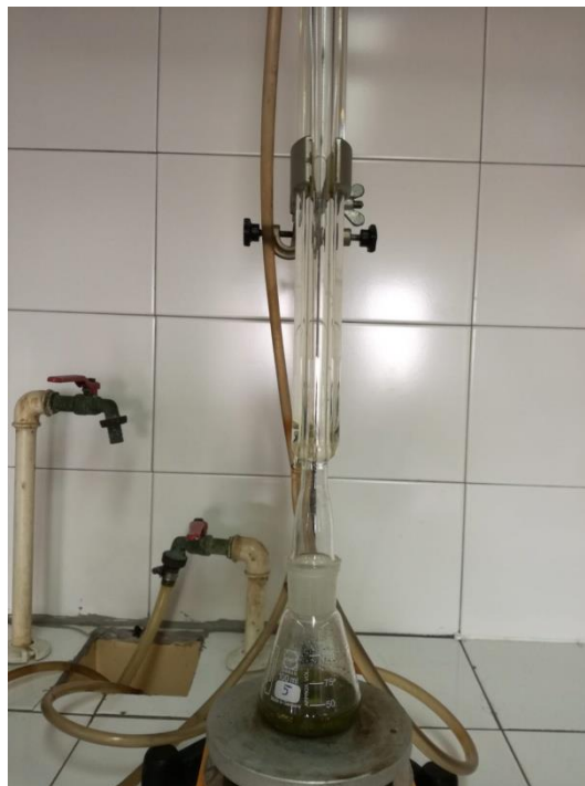
Slika 10. Ekstrakcija refluksiranjem pri temperaturi ključanja otapala
