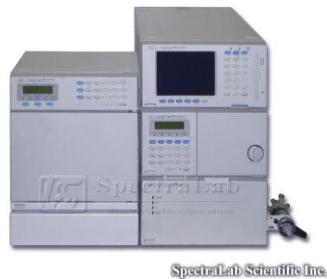
**Slika 6.** Shimadzu HPLC uređaj (Anonimus 6, 2018)
