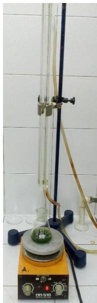
**Slika 12.** Ekstrakcija refluksiranjem (vlastita fotografija, 2018)
