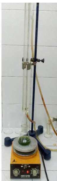
Slika 12. Ekstrakcija refluksiranjem (vlastita fotografija, 2018)
