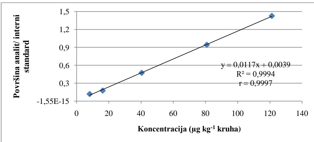
Slika 63. Ovisnost omjera površine i internog standarda o koncentraciji 2-acetyl pirola
