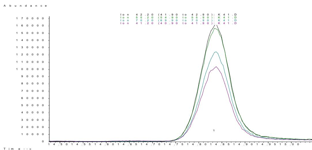
Slika 44. Prikaz kromatograma ciljanog i kvalifikacijskih iona za 1-pentanol
