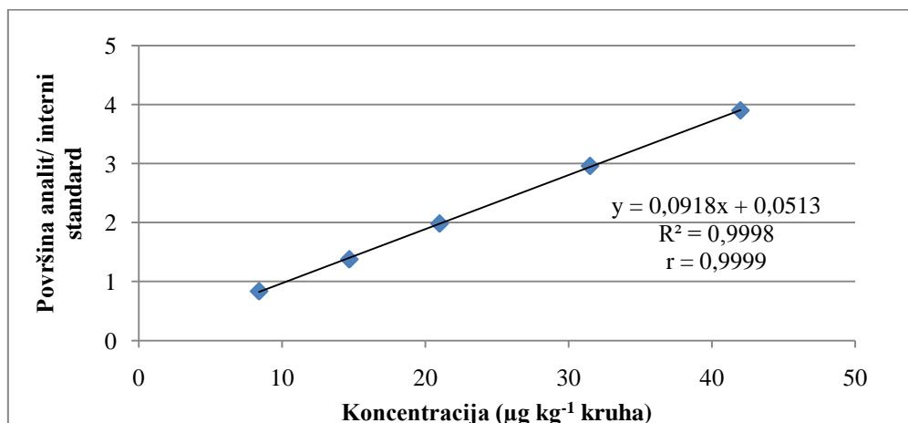
Slika 55. Ovisnost omjera površine i internog standarda o koncentraciji 2-etyl pirazina
