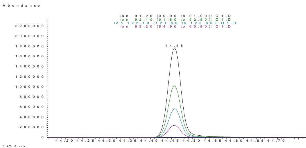
Slika 38. Prikaz kromatograma ciljanog i kvalifikacijskih iona za feniletil alkohol
