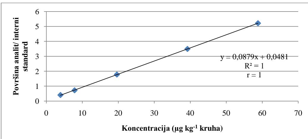
Slika 64. Ovisnost omjera površine i internog standarda o koncentraciji 2-acetyl furana
