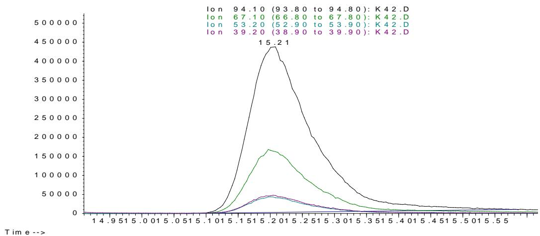
Slika 45. Prikaz kromatograma ciljanog i kvalifikacijskih iona za 2-metil pirazin
