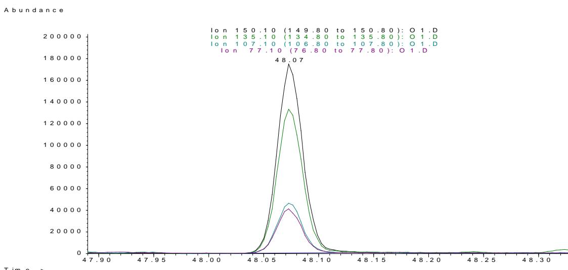
Slika 50. Prikaz kromatograma ciljanog i kvalifikacijskih iona za 2-metoksi-4-vinil fenol
