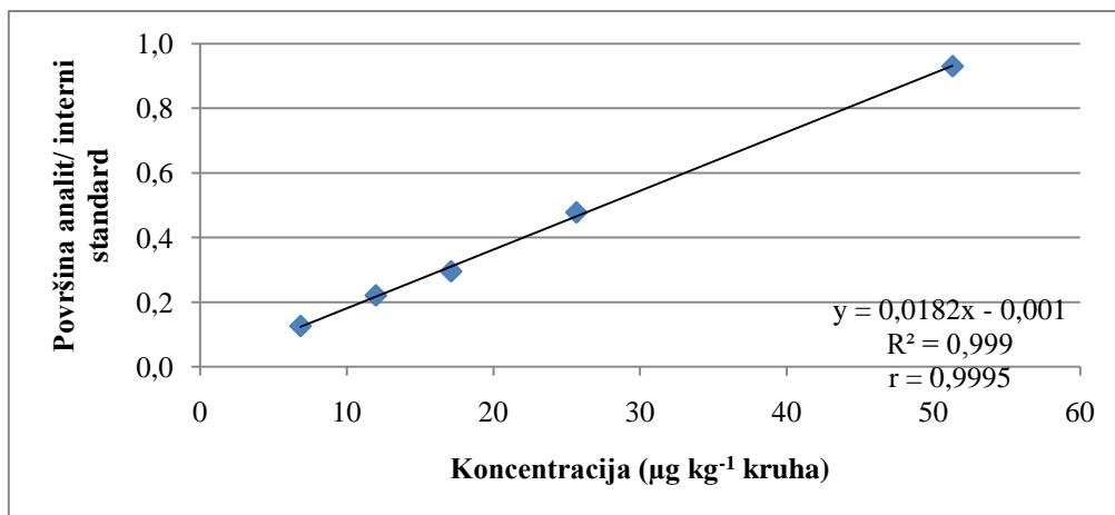
Slika 53. Ovisnost omjera površine i internog standarda o koncentraciji 2-metil furana
