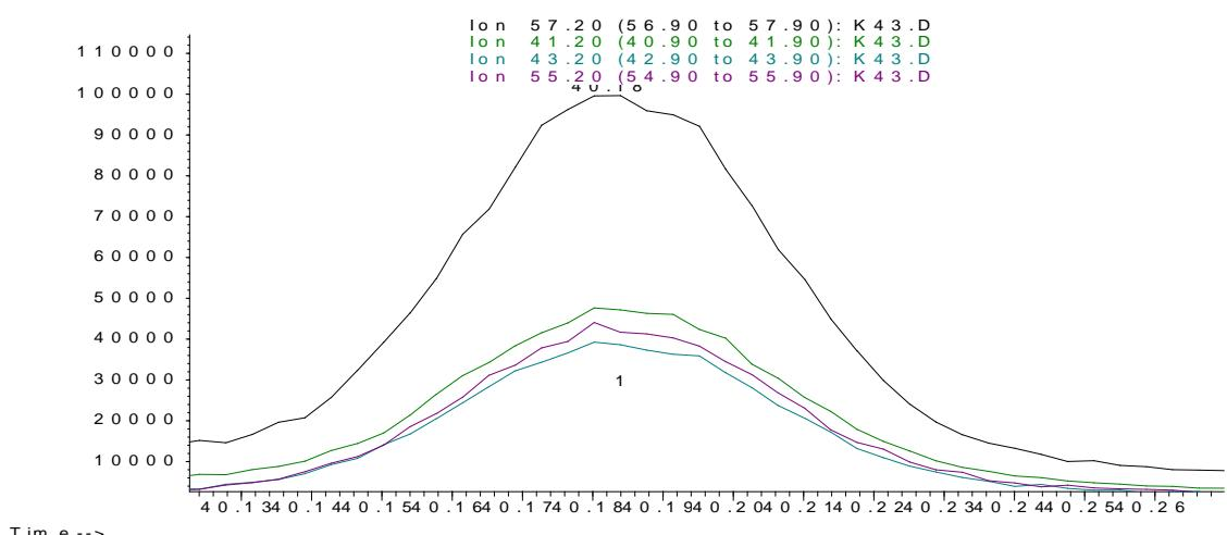
Slika 47. Prikaz kromatograma ciljanog i kvalifikacijskih iona za 2-non-en-1-ol, cis
