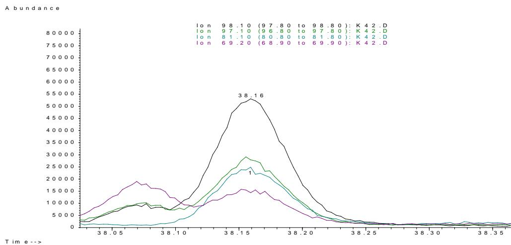
Slika 36. Prikaz kromatograma ciljanog i kvalifikacijskih iona za 2-furan metanol
