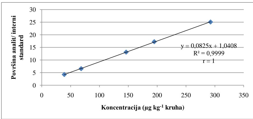
Slika 62. Ovisnost omjera površine i internog standarda o koncentraciji fenyletil alkohola
