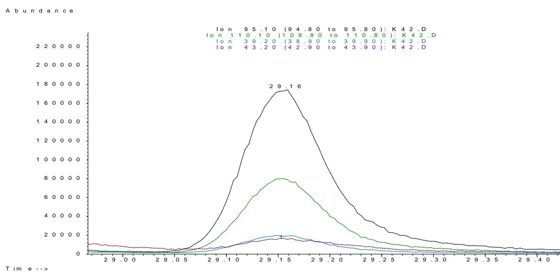
Slika 40. Prikaz kromatograma ciljanog i kvalifikacijskih iona za 2-acetil furan
