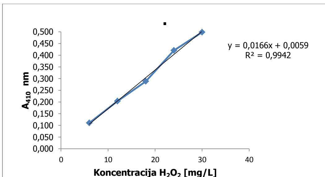
Slika 3. Baždarni dijagram ovisnosti apsorbancije o koncentraciji  $\text{H}_2\text{O}_2$
