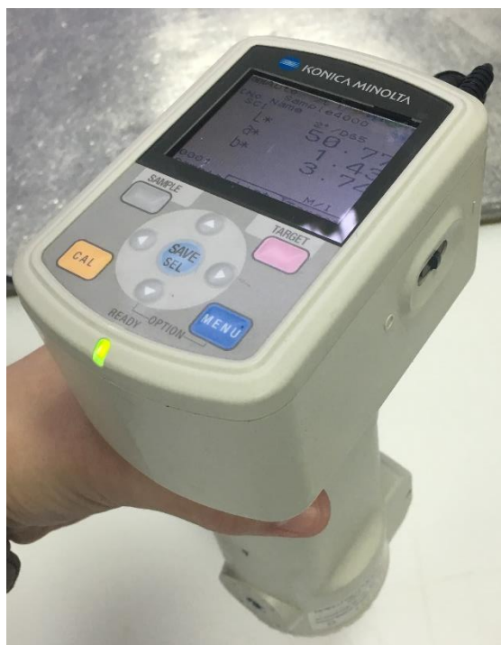
Slika 9. Spektrofotometar Konica Minolta CM-700d (vlastita fotografija)
