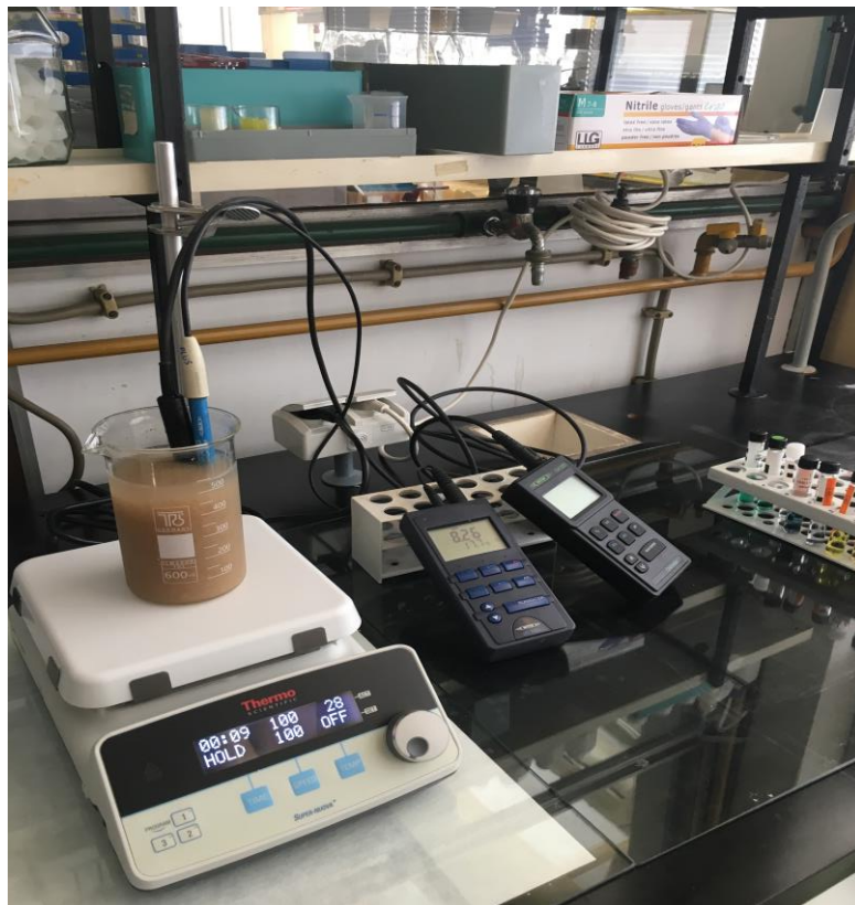
Slika 2. Izgled pokusa denitritirajuće defosfatacije u anoksičnim uvjetima
