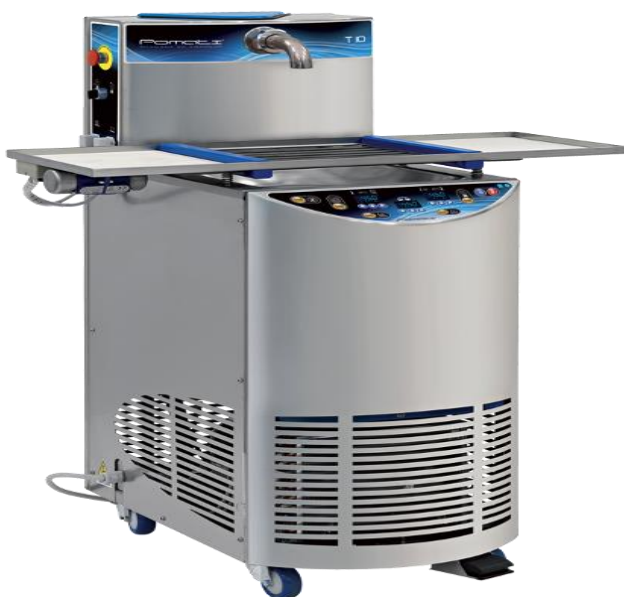
Slika 7. Uređaj za temperiranje čokoladne mase (Pomati, 2016)
