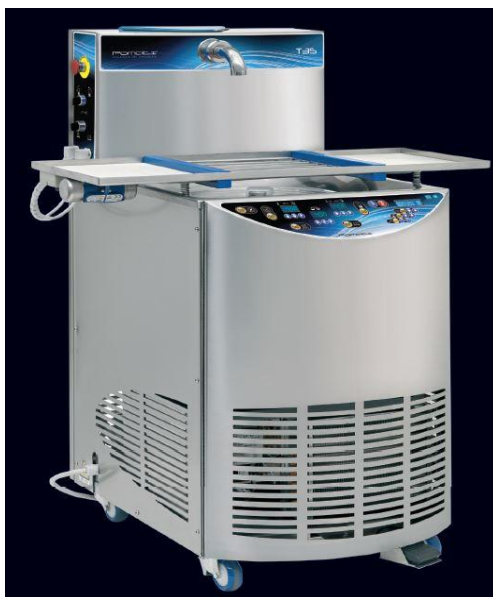
Slika 6. Uređaj za temperiranje čokoladne mase (Pomati, 2016)
