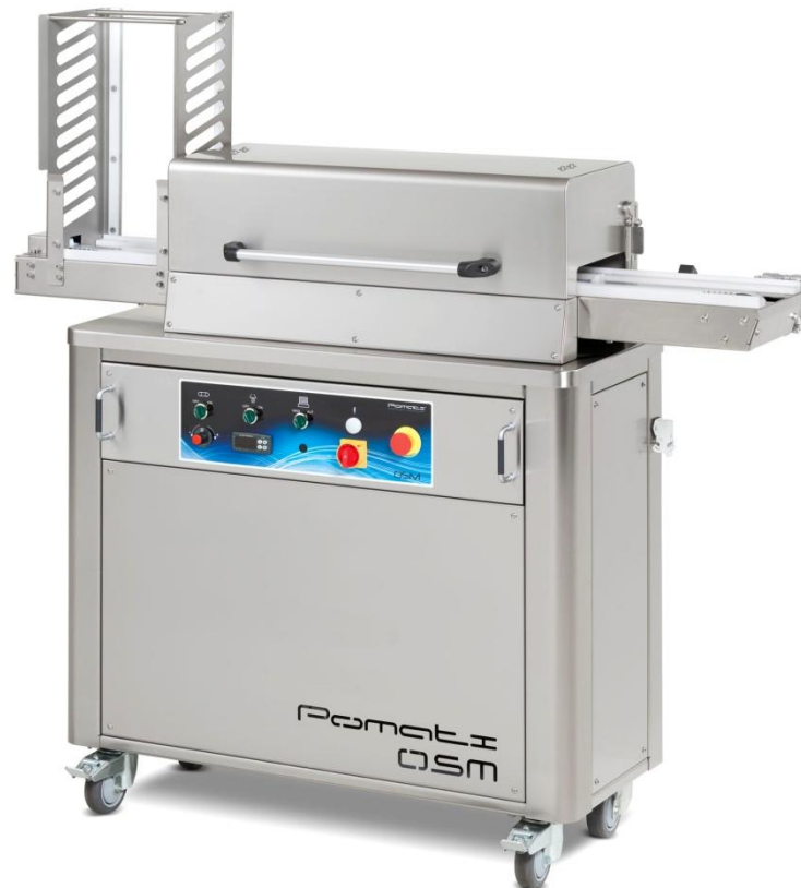
Slika 8. Uređaj za predgrijavanje kalupa (Pomati, 2016)
